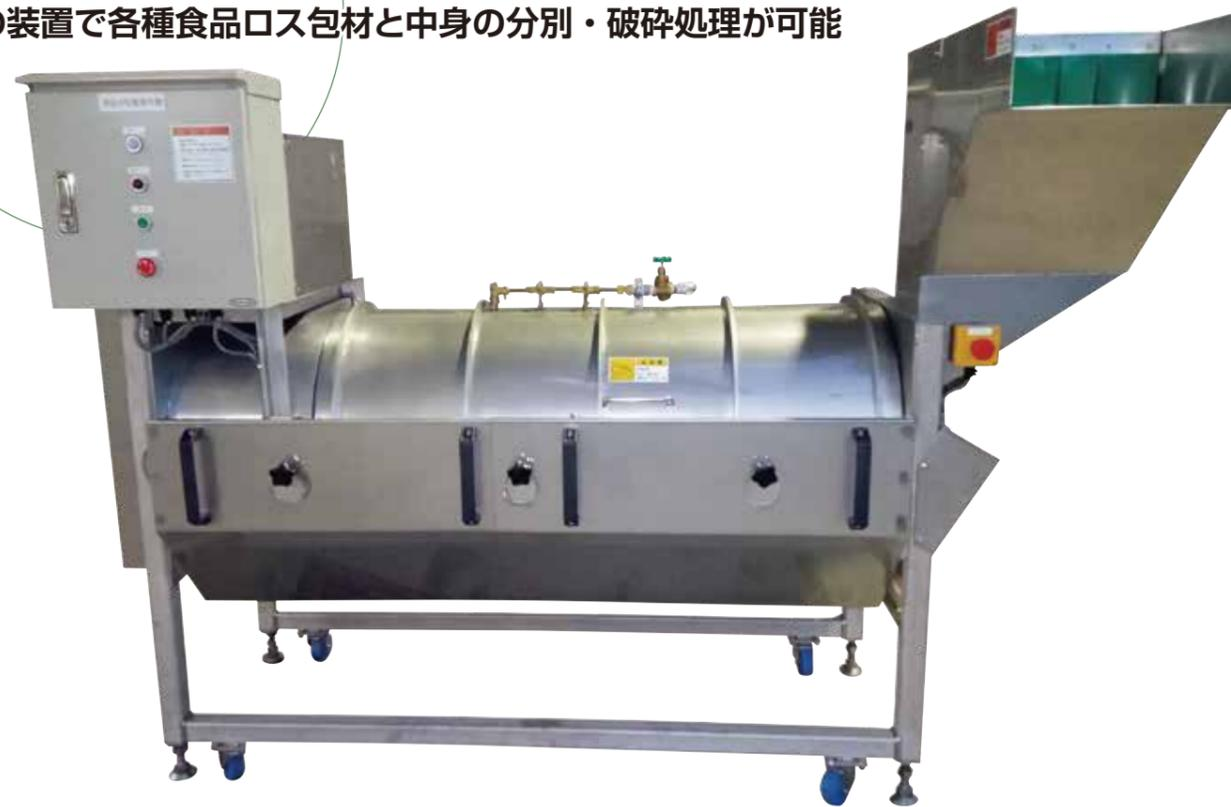
※オプションの水栓ノズル取り付けにより包材の簡易洗浄が可能
